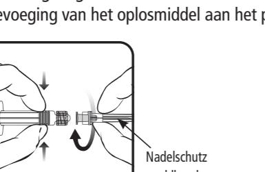
1. Halten Sie den Spritzenzylinder in einer Hand (vermeiden Sie, die Spritze am Kolben zu halten), drehen Sie die Spritzenkappe entgegen dem Uhrzeigersinn ab.
